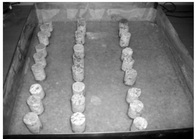
Figure 4. Dispositif d'essai d'absorption capillaire.
