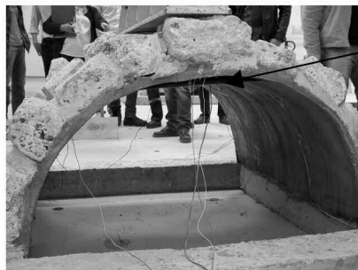
Figure 14. Détachements des fibres de carbone (tissu)
