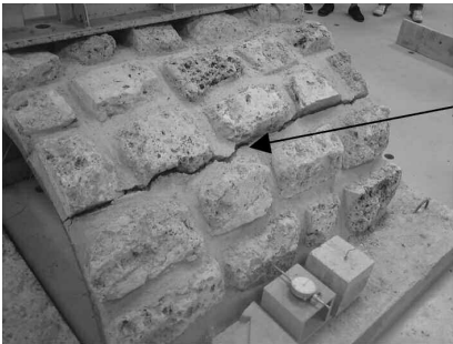
Figure 13. Fissurations au niveau des reins à l'extrados
