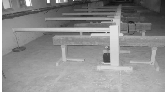
Figure 4 : Poutres sous flexion quatre points
