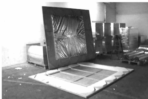
Figure 6 : Construction de l'échantillon avant de le poser dans la Boîte Chaude Gardée.
