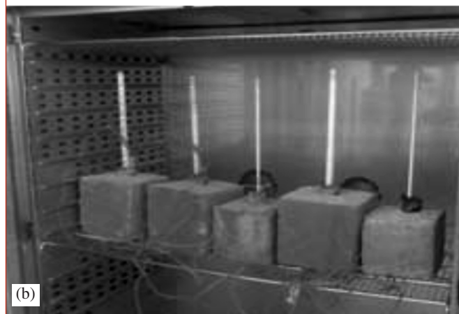
Figure 4: (a) Conditionnement dans l'enceinte climatique (b) Thermocouples.
