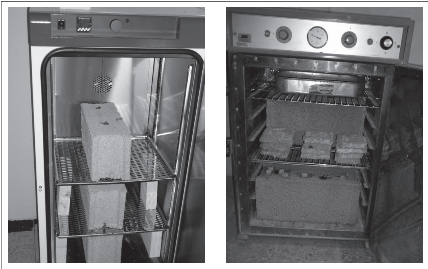
Figure 10. Séchage des blocs dans une étuve ventilée à 33° C.
