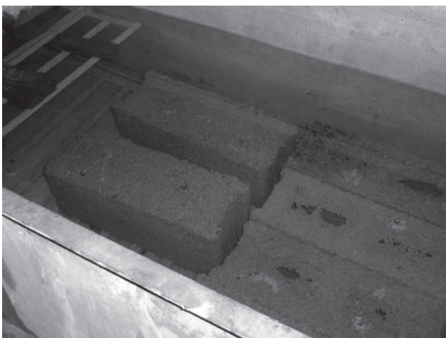
Figure 11. Mesure du gonflement par immersion (blocs dans le bac à eaux).
