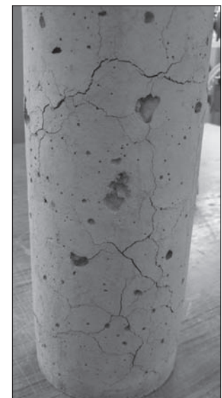
Figure 7 : cliché d'une éprouvette de B40SC à la suite d'un cycle de chauffage / refroidissement.
