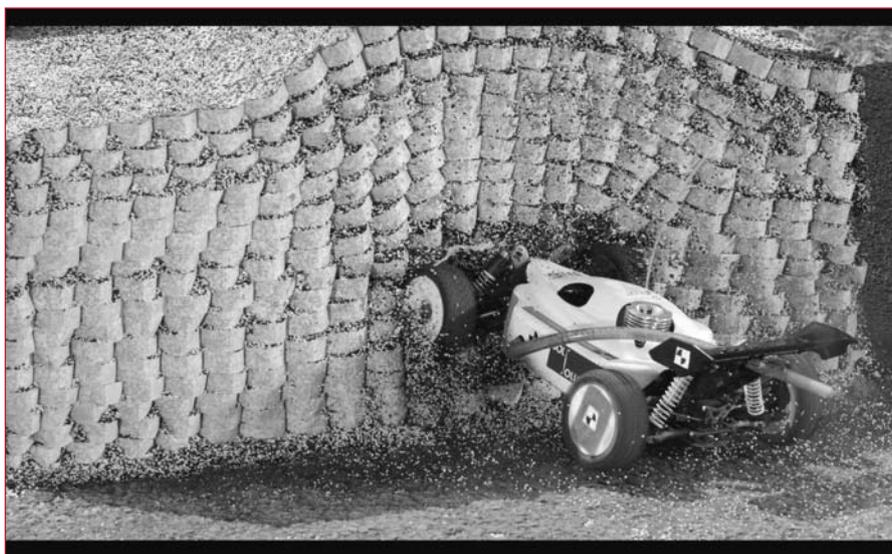
**Figure 5. Expérience d'impact d'un véhicule sur un ouvrage en sol renforcé à échelle 1/10<sup>e</sup>**
