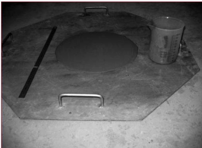
Figure 6. Mesure du seuil de cisaillement selon Roussel et Coussot
