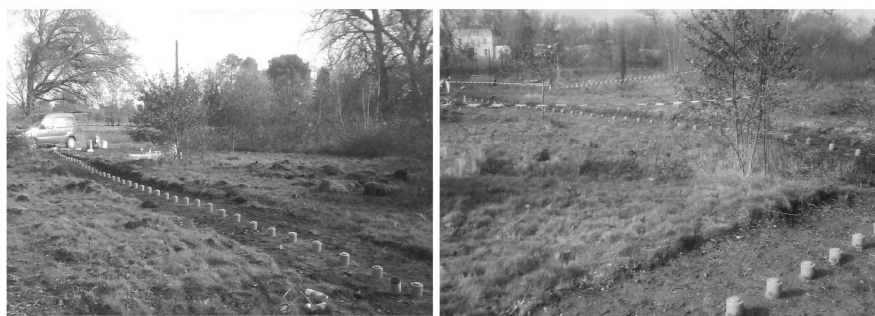
Figure 2. Dispositif de tomographie de résistivité électrique installé à demeure sur le site expérimental de Pessac.
